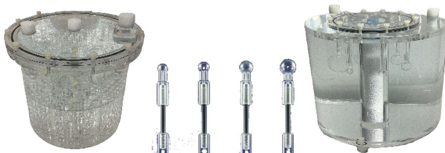
FIGURE 2.5 – Objets test de Jaszczak, microspheres et NEMA IEC PET Body Phantom Set™ .
