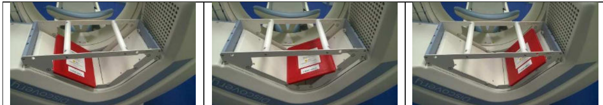
Figure 19 : Porte source placée sur l'arceau de la caméra et positions de la source plane 1, 2 et 3 pour la réalisation du contrôle quotidien.
