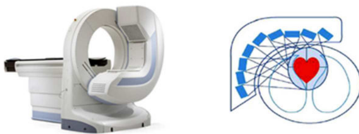
Figure 4 : Présentation de la caméra à semi-conducteurs Discovery-NM530c (GE Healthcare) et de la géométrie de la rangée centrale de détection (22).
