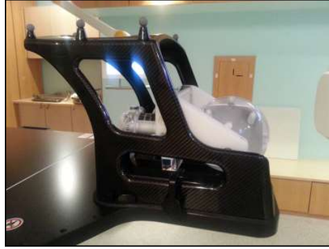
Figure 5.2 : Test de positionnement : Pré positionnement du fantôme Lucy au moyen du boîtier de pré positionnement infra rouge et du système ExacTrac Brainlab.
