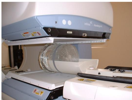
**Figure 3-18.** Dispositif d'acquisition pour le test des performances globales en conditions de TEMP cérébrale.
