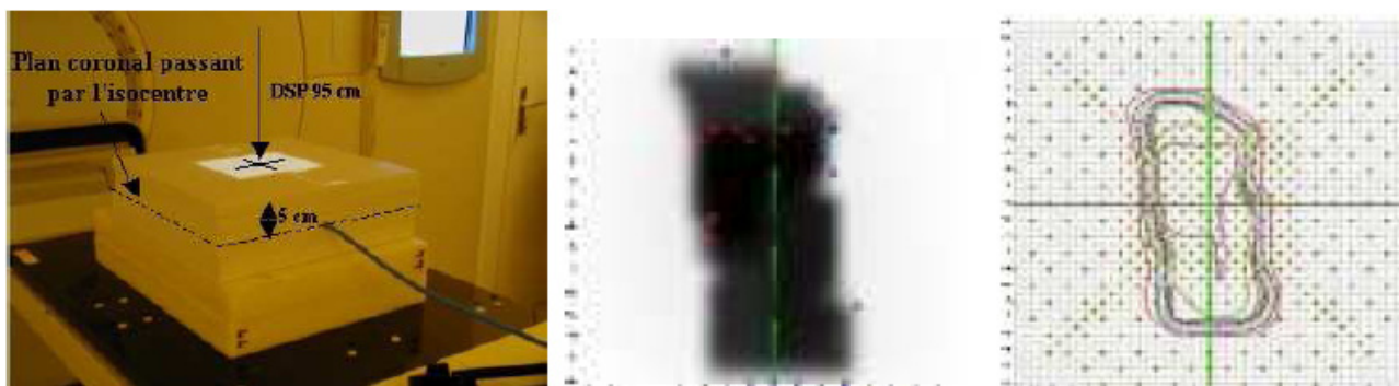
Figure 30 : Exemple de vérification de distribution de dose, méthode faisceau par faisceau [Marcié 2005a].
