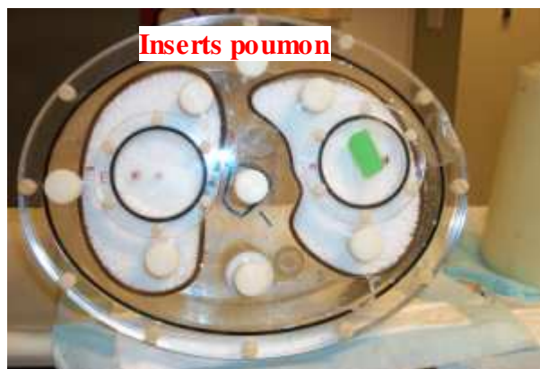
Figure 2.11 : Exemple d'un objet test thoracique avec deux inserts poumon, de type Elliptical Lung-Spine Body Phantom™ .
