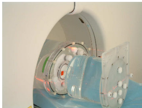
Figure 2.13 : Positionnement des deux objets test sur le lit du tomographe.
