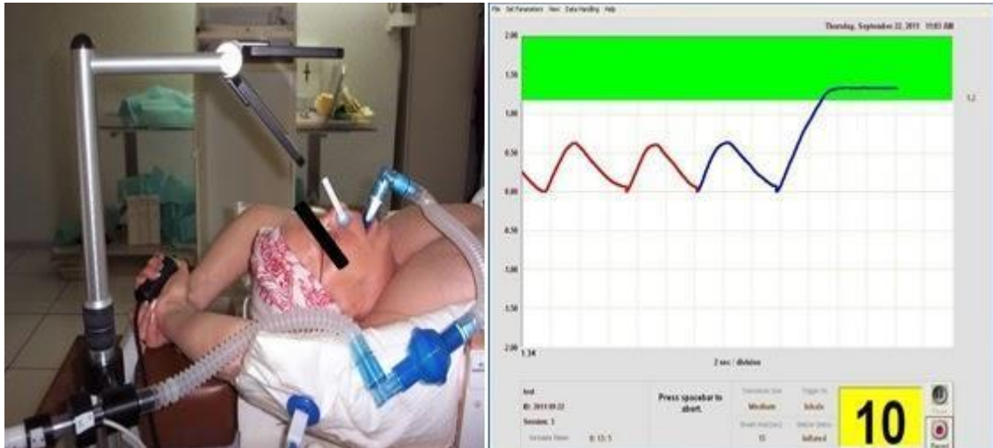
Figure 2.2 : Le patient regarde l'interface placée en bout de table via le jeu de 2 miroirs à 45°. Le niveau de blocage à atteindre est défini dans la zone verte. Un décompte du temps restant s'affiche à l'écran (Images CH Orléans).
